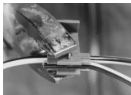
6 Для муфт с выводом 3-х и более кабелей с помощью обжимного соединителя подключите дополнительный провод к основному проводу обеспечения непрерывности экрана.
