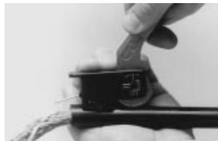
2 Для монтажа провода непрерывности экрана от среза оболочки в сторону кабеля сделайте ручным инструментом два продольных разреза оболочки. (Длина разрезов 20 мм, расстояние между ними 10 мм).
